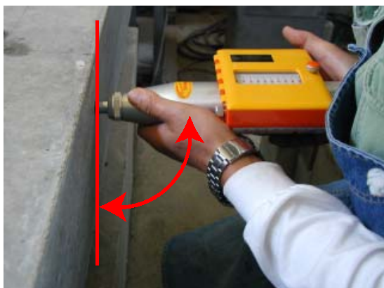
写真左 反発度の測定状況 上下方向の角度に注意！
