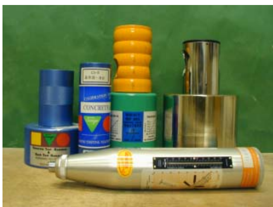
写真左上 テストアンビルによるリバウンドハンマーの点検状況
