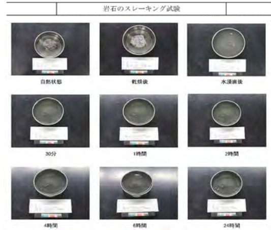
写-5 スレーキング試験経過写真
