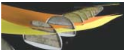
図-7 切羽写真を組み込んだCIMモデル 4)
