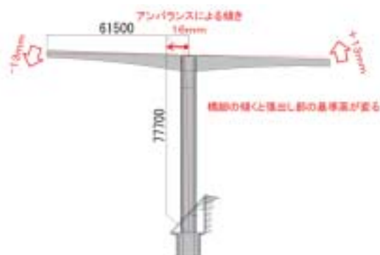
図-6 下部工の橋軸方向の変位 (傾き)
