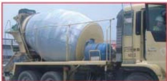
写真-3 コンクリート運搬時遮光カバー設置状況
