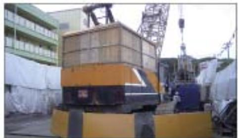
クローラクレーンに装着した防音壁
