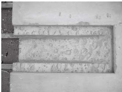
図-3 模擬試験体下面の気泡滞留状況
